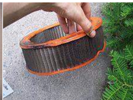
Filtre à air cylindrique usé
