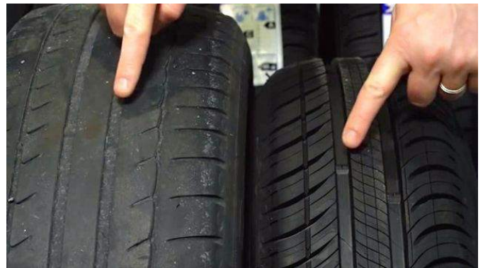
Témoins d'usure sur pneu neuf et usagée
