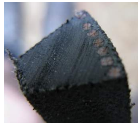
Section d'une courroie trapézoïdale de type SPA
