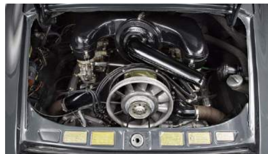
Porsche 911 équipée d'un moteur 6 Flat refroidi par air
