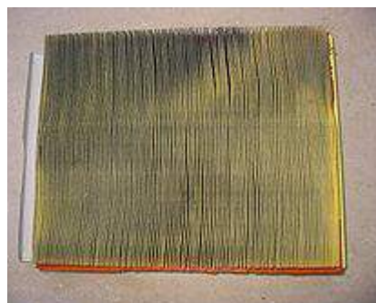
Filtre à air de voiture usé, de dos
