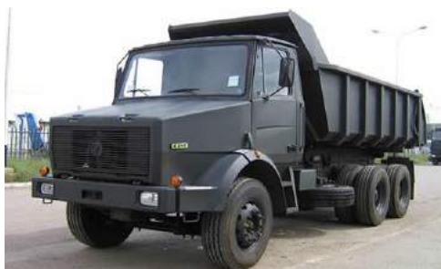
Camion SNVI B260, équipé d'un moteur V8 diesel refroidi par air
